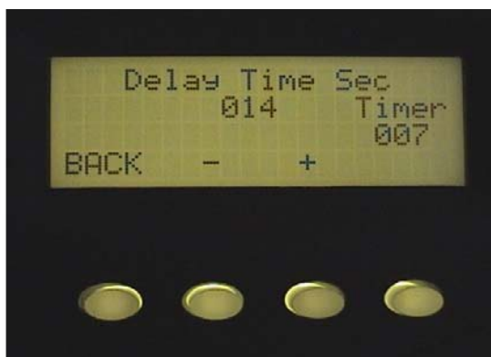
Low Battery Disconnect Spänningsinställning Low Battery Disconnect Time - Fördröjningstid
