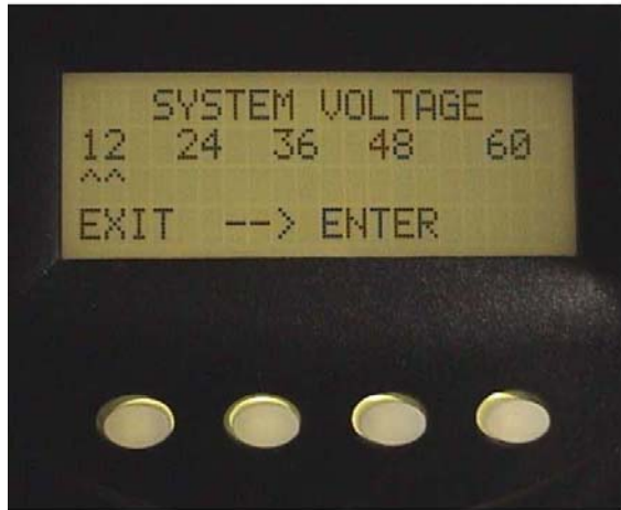
Bild för inställning av systemspänning
