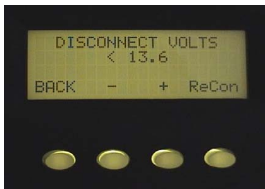
Low Battery Disconnect Spänningsinställning Low Battery Disconnect Time - Fördröjningstid
